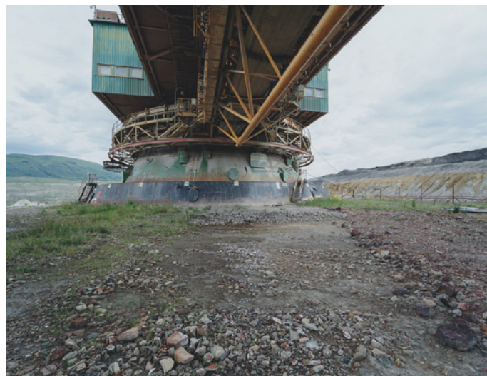
Obr. 8 Kráčejší podvozek rypadla RK 5000 s konstrukcí vynášecího pásu, foto: Jan Kuták
