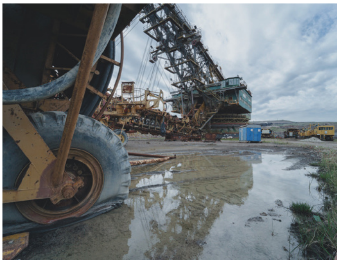
Obr. 7 Kráčejší rypadlo RK 5000, které sloužilo pro těžbu nadložních zemin ve velkolomu ČSA, foto: Jan Kuták
