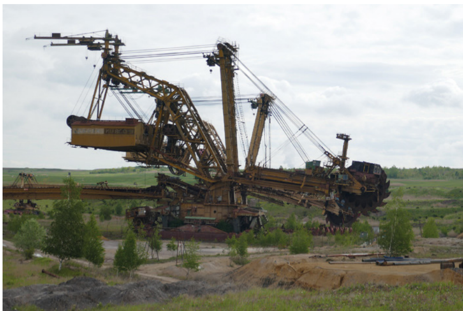
Obr. 3 Velkorypadlo KU 800, foto: Lenka Popelová
